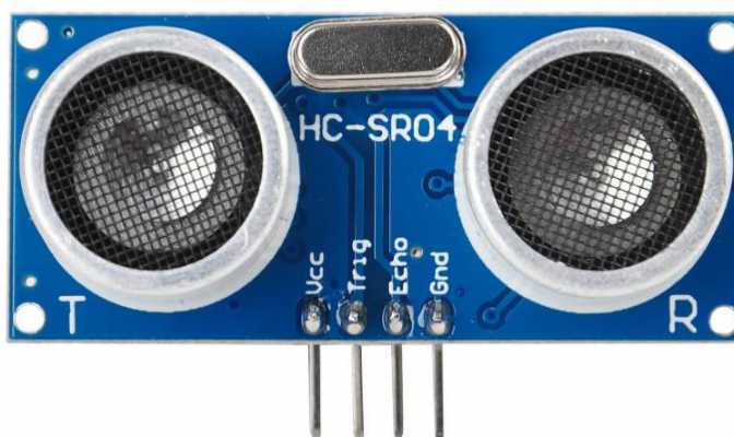
2.1 - сурет – HC-SR04 ультрадыбыстық сенсоры
